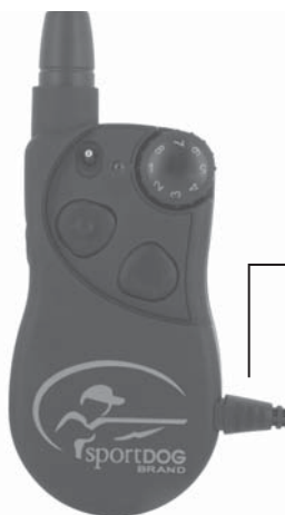
CONECTOR DEL CARGADOR COLOCADO EN LA TOMA DE CARGA DEL TRANSMISOR
